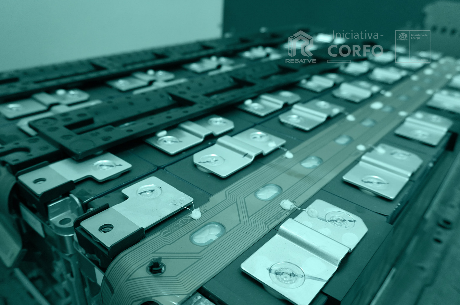
Fotografía: Batería de vehículo eléctrico en laboratorio de REBATVE / Equipo de Divulgación y Vinculación E2Tech
